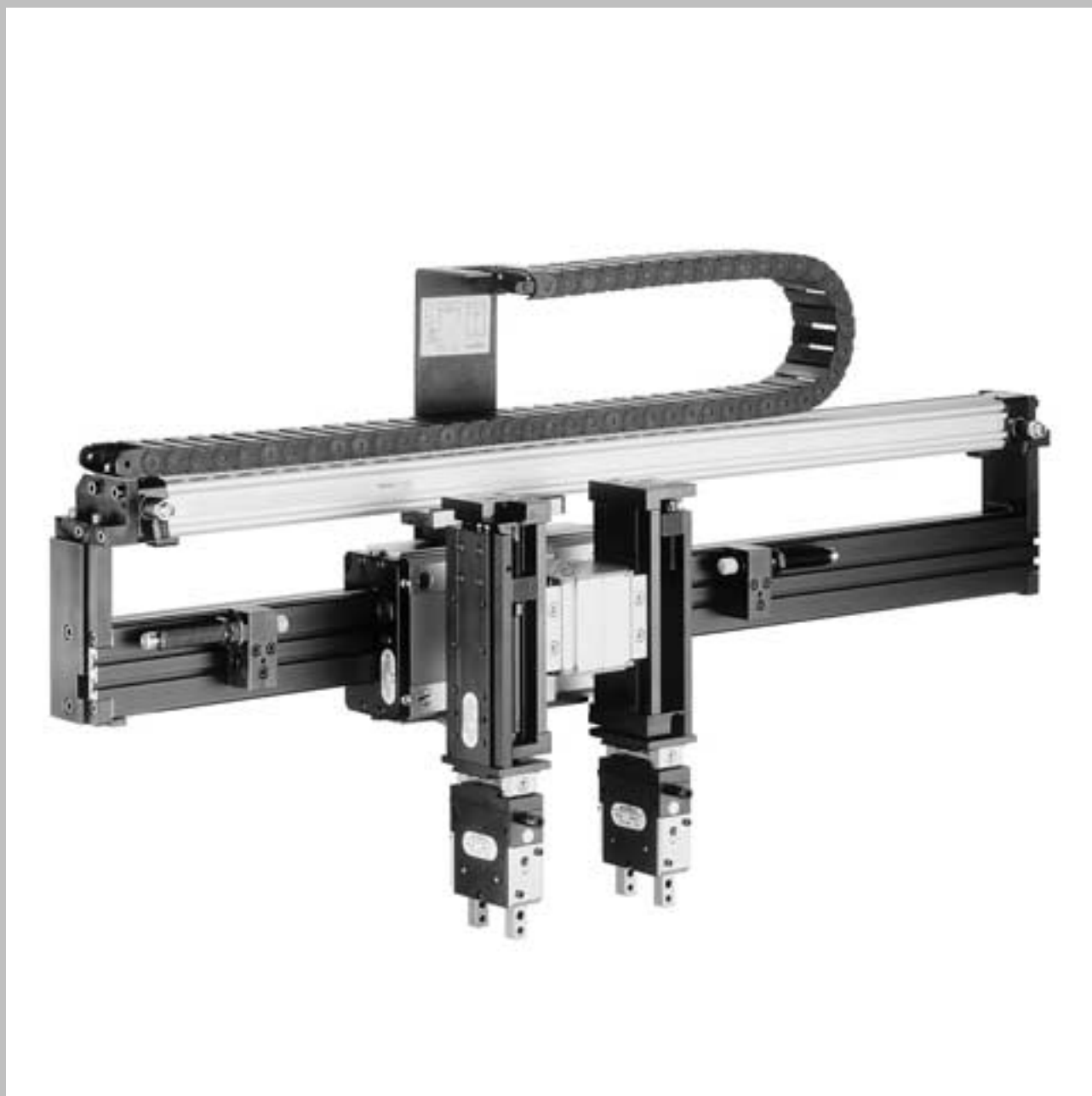
Caricatore a portale; due slitte compatte KSD, con pinze parallele GPD a doppia azione, montate con un profilato portante TP-66-40 ed un elemento di fissaggio longitudinale-longitudinale SLL-55-40 su una slitta a portale PS.
