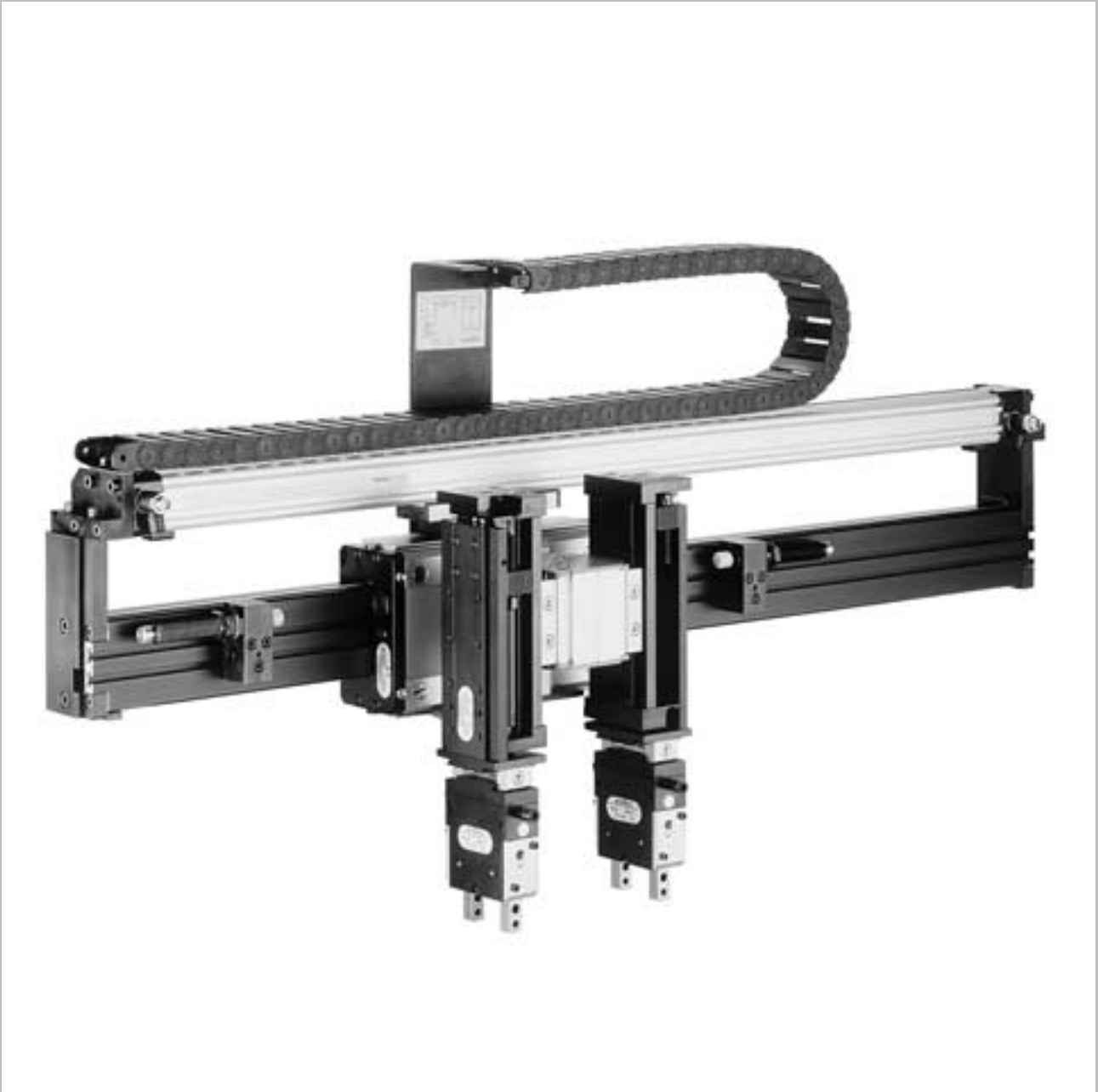
Übersetzeinheit in Portalbauweise; zwei Kompaktschlitten, mit doppelwirkenden Parallelgreifern GPD, sind mit einem TP-66-40 und SLL-55-40 an einem Portalschlitten PS angebaut.
