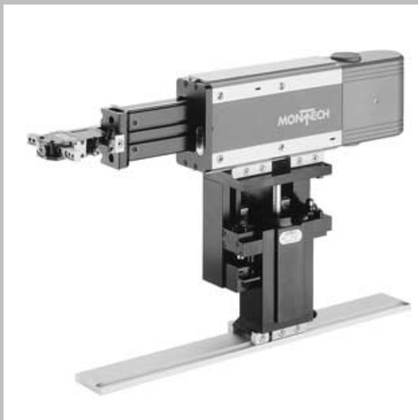
Station de déchargement; composé d'une coulisse de base HE, d'une unité linéaire horizontale LEP et d'une pince angulaire GW.
